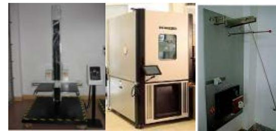
各类测试设备，如跌落测试仪，热力测试仪，等
